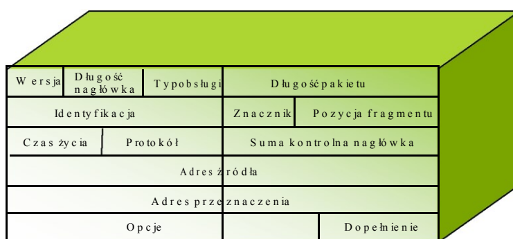
Rysunek 4-1. Format nagłówka pakietu IPv4 [RFC0791]
