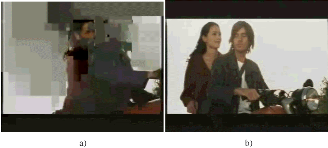
Rys.10. Ekran aplikacji RealPlayer uruchomionej w warunkach przeciążenia a) w sieci tradycyjnej i b) w sieci z jakością obsługi, z parametrem SBR = 264 kbit/s.
